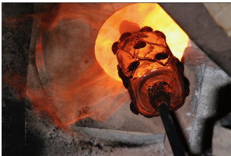
Proceso de trabajo de botella de vidrio soplado S'Arxiduc, ca. 2021 ©Fotografía: Vidrierías Gordiola, Algaida (Mallorca)
